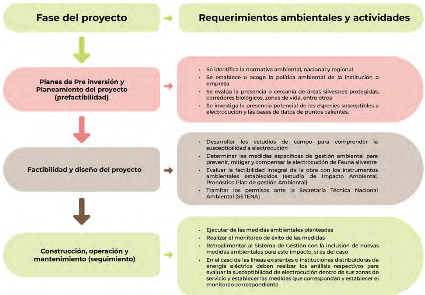
Figura 16. Requerimientos de análisis ambiental para la prevención del impacto de electrocución en Costa Rica.
