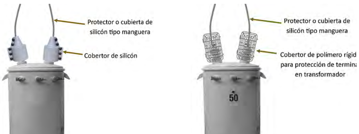
Figura 37. Cobertores de goma siliconada y cobertores poliméricos rígidos para aislar los puntos de contacto y partes energizadas.
